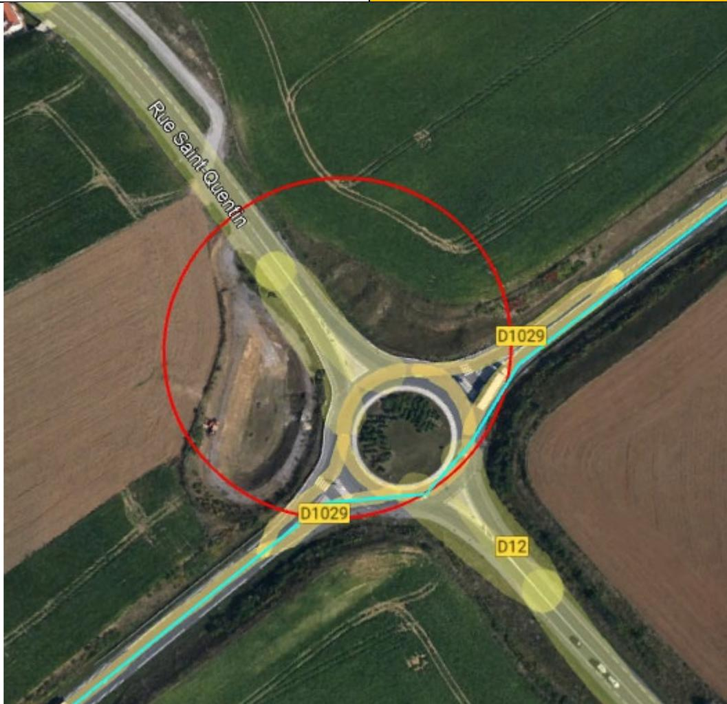
Aménagement de surface à faire pour permettre le passage des pâles. Il est probable qu'aucun aménagement ne soit nécessaire
